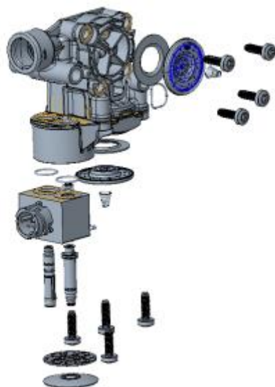
(Vista explodida do conjunto completo/ Válvula moduladora)
