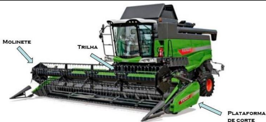
Exemplo da utilização dos atuadores em colheitadeira de grãos
