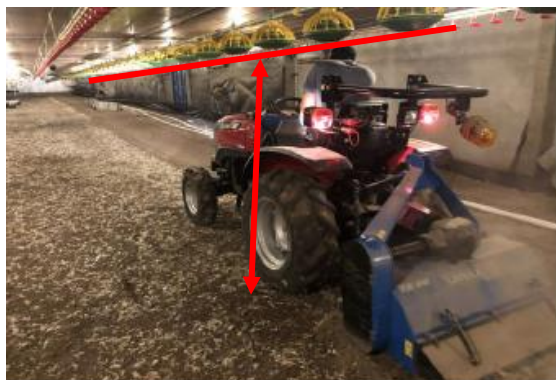
Imagem 2 – Tratores SOLIS 26 em operação de remoção de cama de aviário com lâmpadas na altura de 1,5m
