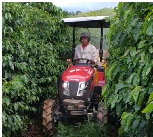
Imagem 10 – Tratores SOLIS 26 em operação de pulverização no café adensamento com distância de 1,5m entre plantas
