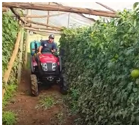
Imagem 11 – Tratores SOLIS 26 em operação de pulverização de tomates com largura de 1,6m.
