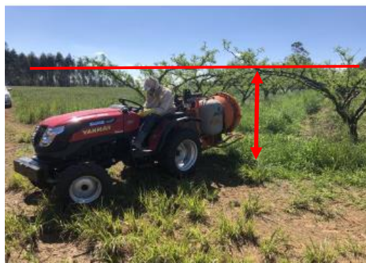
Imagem 3 – Tratores SOLIS 26 em operação de pulverização de pêssego com altura de 1,5M
