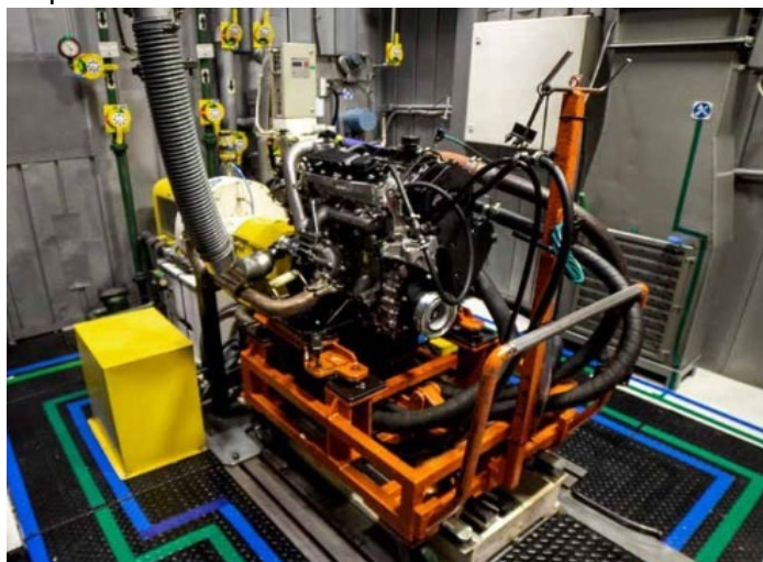
Figura 3 - Setup de testes de motor em dinamômetro, Fonte: Google Imagens
