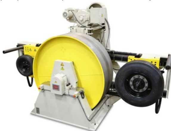
Figura 1 - Exemplo setup de testes para resistência ao rolamento dos pneus - Fonte: GOOGLE IMAGENS
