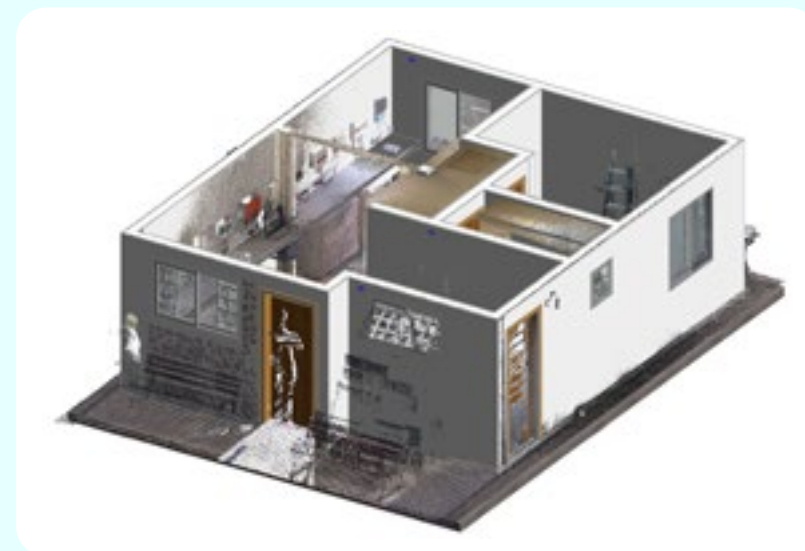
Figura 15 - Atualização do modelo BIM com base na nuvem de pontos
