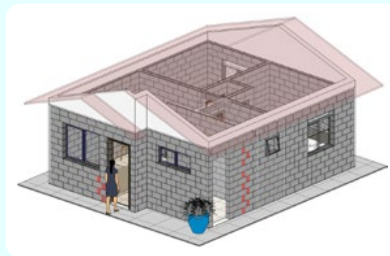
b) Modelo BIM para alvenaria de blocos de concreto
