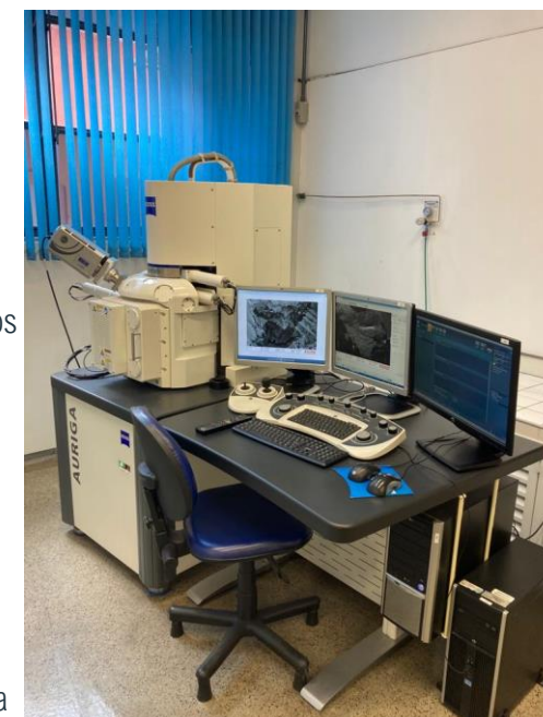
Foto: Microscópio Eletrônico por varredura, para análise de superfícies metálicas, SENAI SP
