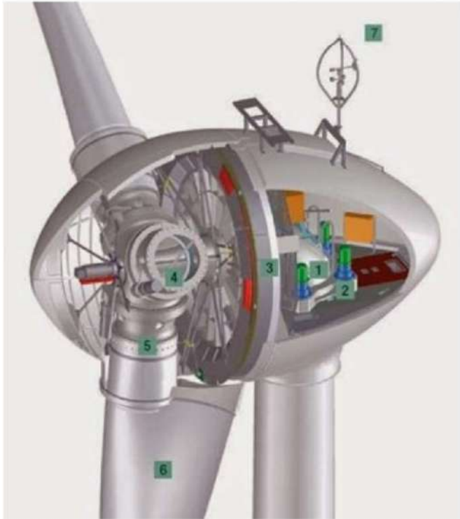
Figura 2. Vista do interior da nacele de um aerogerador utilizando um gerador multipolos.
