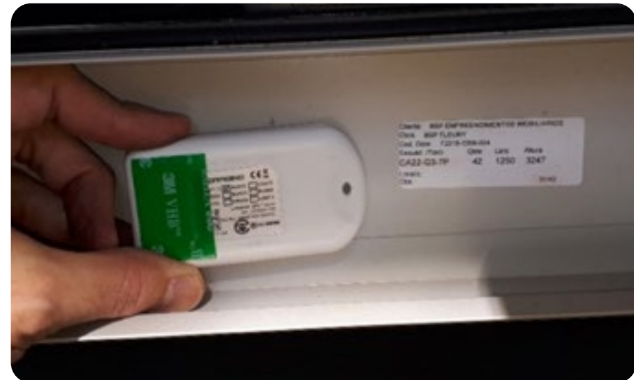
Figura 9 - Registro para associar a identificação do dispositivo com a da esquadria no modelo BIM.
