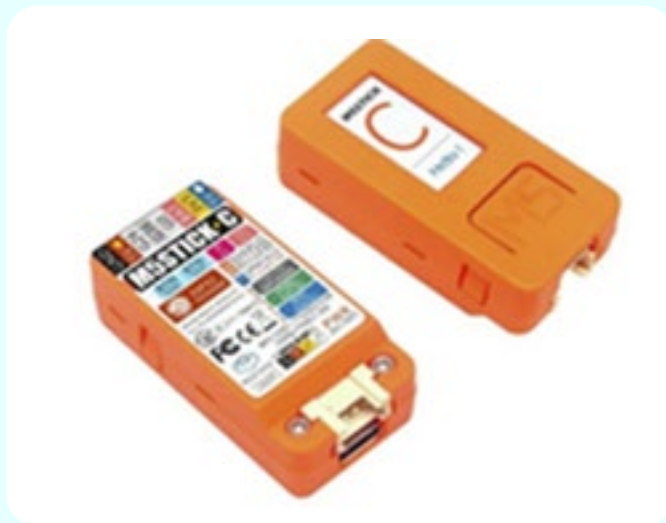
Figura 12 - Dispositivo M5StickC da M5Stack adotado para o experimento
