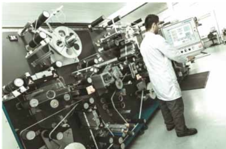
Figura 52 – Produção de Etiquetas RFID na Valid Sorocaba
