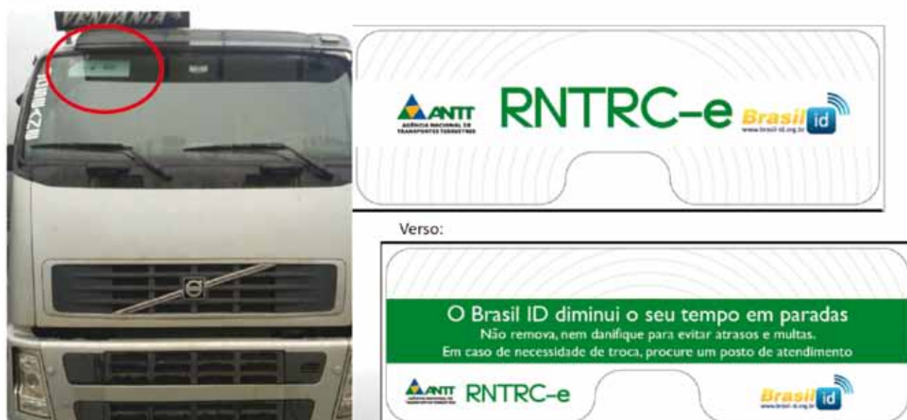
Figura 17 – Modelo e local de instalação do adesivo/tag para o projeto-piloto no porto de Santos
