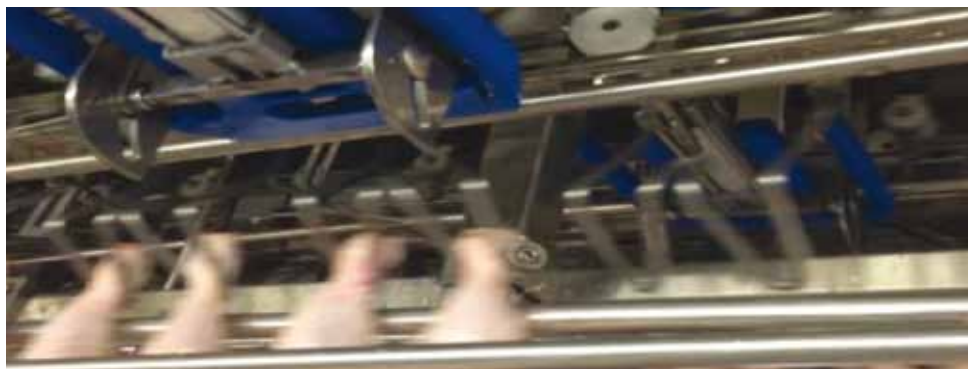
Figura 45 – Pesagem das aves e gravação do peso na etiqueta RFID no gancho
