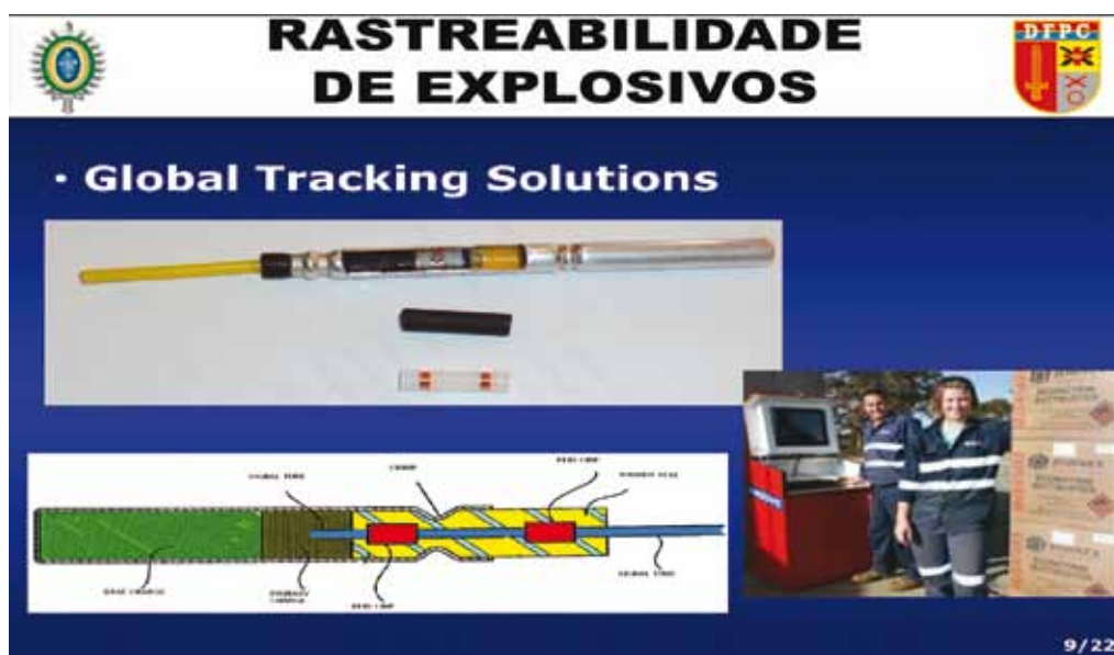
Figura 9 – Etiquetas Inteligentes aplicadas às espoletas
