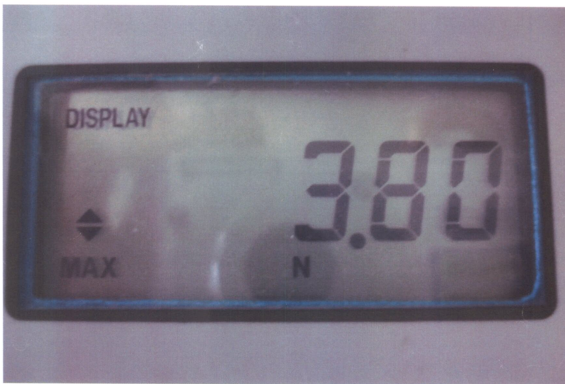
FOTO N.º 02 – DETALHE DO INDICADOR DE CARGA REGISTRANDO A CARGA 380g
