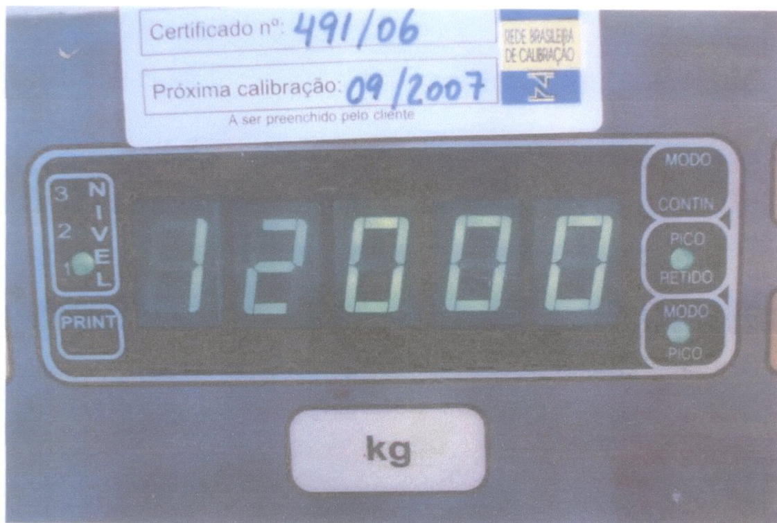
FOTO N.º 04 – DETALHE DO INDICADOR DE CARGA REGISTRANDO A CARGA 12000 kgf
