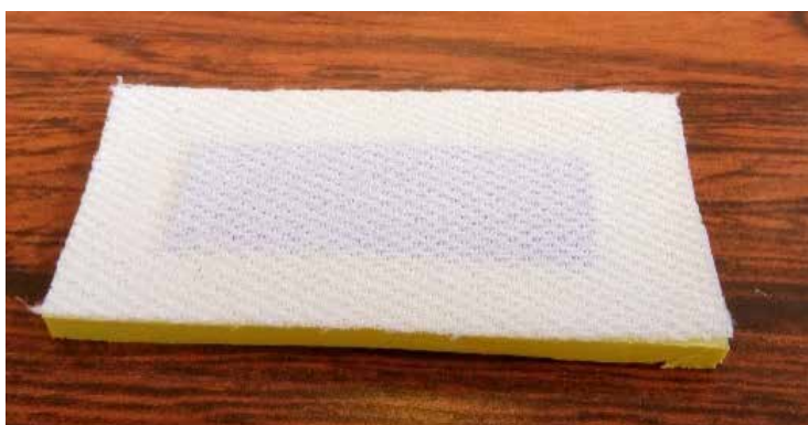
Figura 4: Estrutura sanduíche do material da palmilha, material (função), de cima para baixo: tecido (proteção)/filme termocolante (fixação)/filme condutor em nanografite (aquecedor) /filme termocolante (fixação) /filme EVA (amortecimento). Colaboração: Dublauto.
