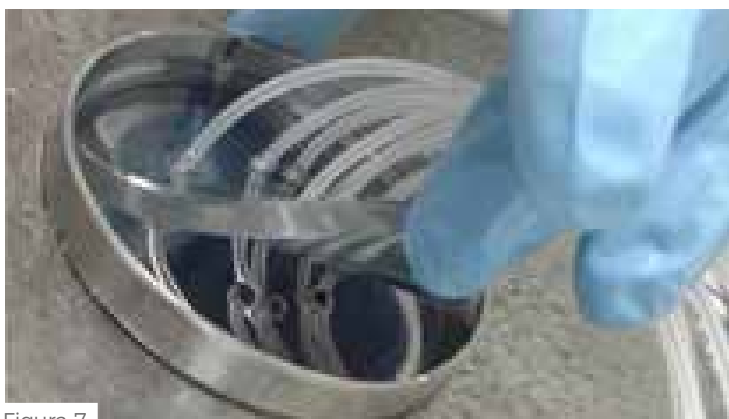
Figura 7: Dispositivo microfluídico fabricado em vidro e PDMS.
