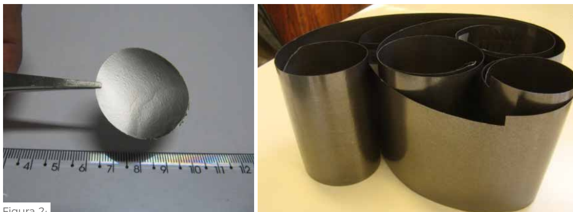
Figura 2: Filmes finos flexíveis altamente condutores fabricados a partir de nanofitas de grafeno. Colaboração: Nacional de Grafite.
