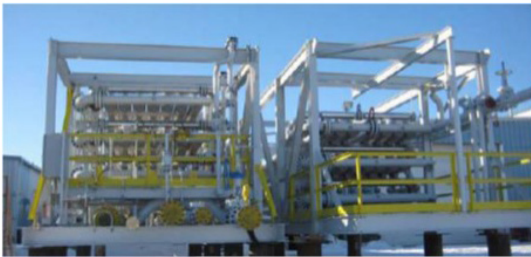
Figura 35 – Skids com Módulos de Membranas do Tipo UOP Separex TM
