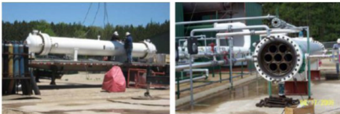
Figura 37 – Módulos de Membrana do Sistema UOP Separex™
