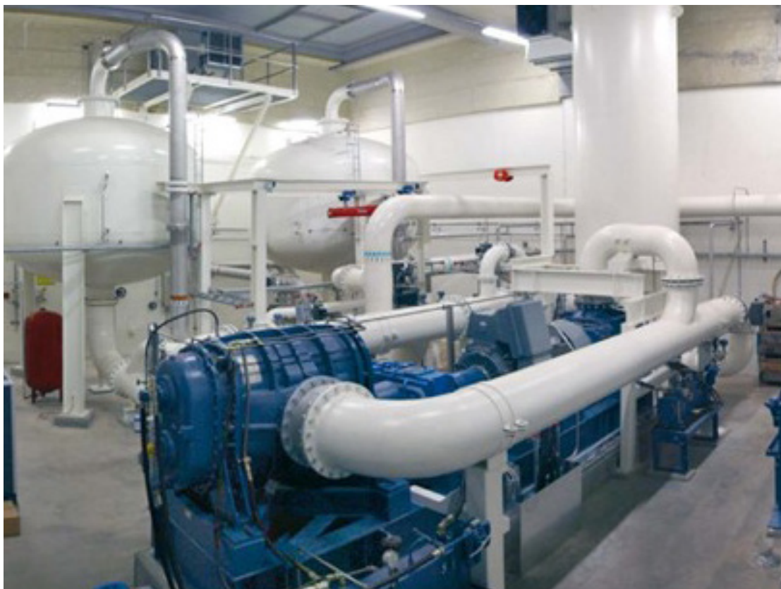
Figura 14 – Unidade VPSA para 1.300 Nm 3 /h de Oxigênio
