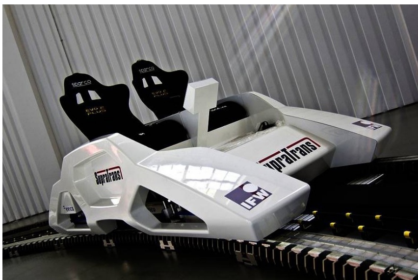
Figura 140 – Protótipo de Veículo de Levitação Supercondutora Desenvolvido pelo IFW na Alemanha
