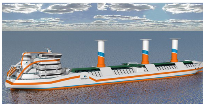
Figura 72 – Ilustração de uma Embarcação Provida de Rotores Flettner
