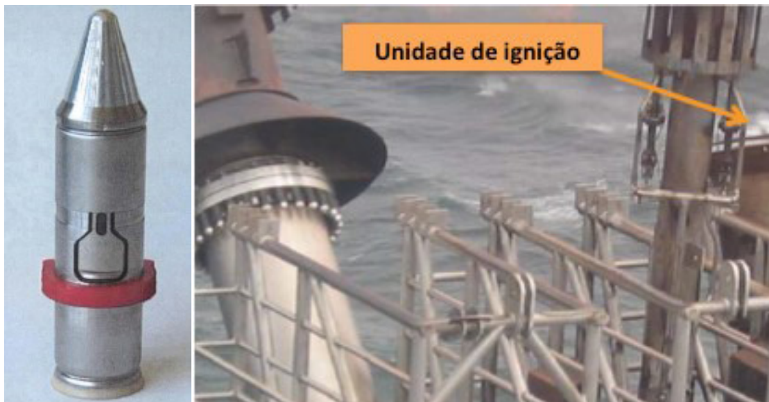
Figura 28 – Piloto de Ignição e Unidade de Ignição
