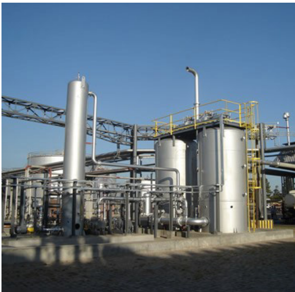
Figura 22 – Unidade de Recuperação de Vapor
