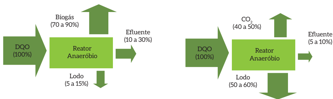
Figura 42 – Conversão Biológica nos Processos Aeróbio e Anaeróbio
