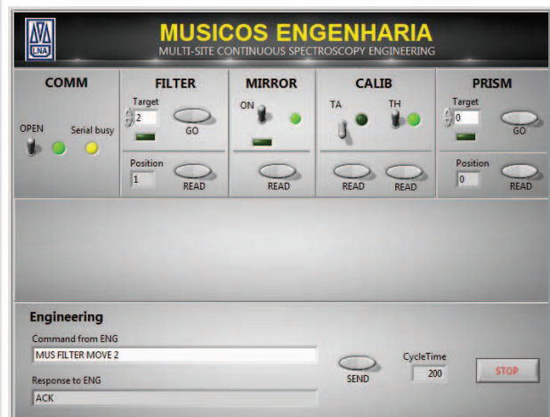
Figura 3 Tela do Painel Frontal MUSICOS ENGENHARIA (versão para manutenção e testes)
