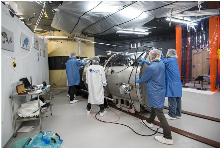
Figura 1.6.3 - Foto do espectrógrafo SPIRou no momento em que a câmara criogênica está sendo fechada para iniciar o primeiro ciclo térmico (© S. Chastanet - CNRS/OMP).
