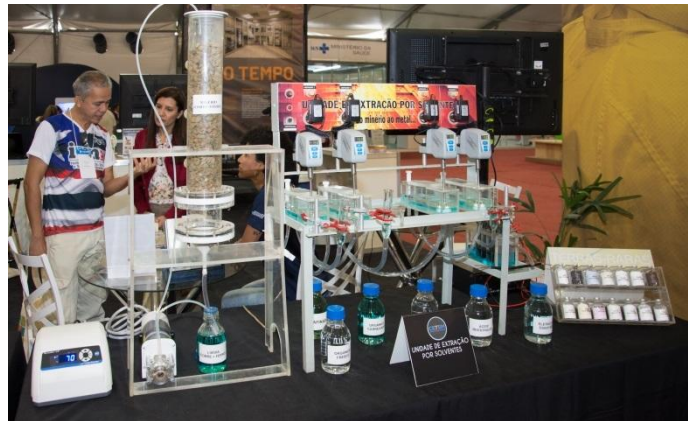
Foto – Protótipo de unidade de extração de solvente. Fonte: Comunicação.
