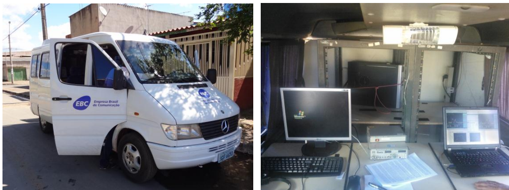
Figura 10- Viatura móvel adaptada com detalhes dos equipamentos de medição
