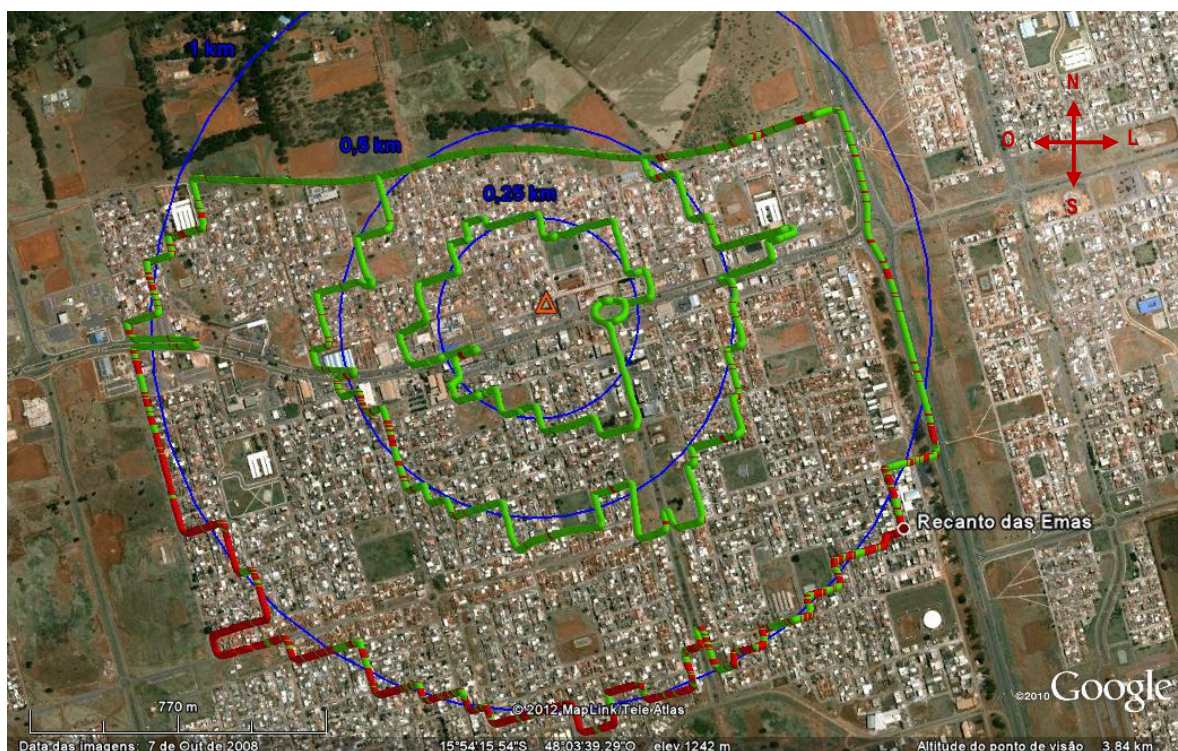
Figura 22-Resultados da recepção móvel nas rotas circulares no modo 4QAM
