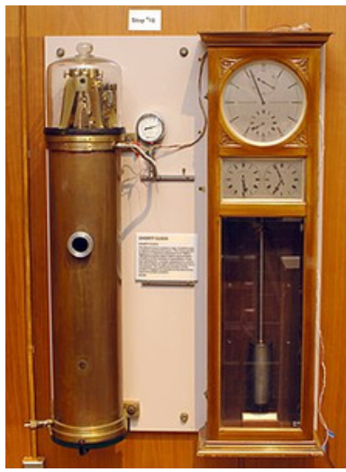
Figura 8: o pêndulo duplo de Shortt: O relógio primário fica dentro de uma câmara a vácuo e o relógio secundário. Fonte: https://en.m.wikipedia.org/wiki/Shortt%E2%80%93Synchronome_clock
