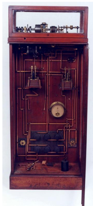
Figura 24: Transmissor automático de sinais horários Belin. Fonte; Coordenação de Museologia do MAST.
