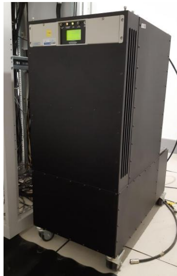
Figura 21: Padrão atômico de MASER de hidrogênio. Fonte: Autoria própria, 2024.
