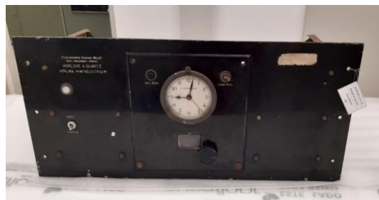
Figura 15: Relógio de quartzo da Etablissements Edouard Belin. Fonte: Autoria própria.
