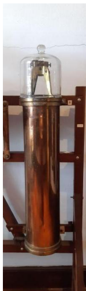
Figura 12: Pêndula a vácuo Shortt. Fonte: Autoria própria.
