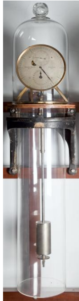
Figura 11: Pêndula a vácuo Riefler. Fonte: Coordenação de Museologia do MAST.
