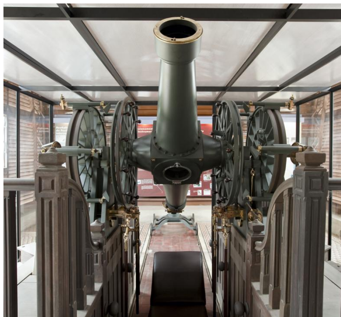
Figura 7: Círculo Meridiano de Gautier. Fonte: Coordenação de Museologia do MAST.
