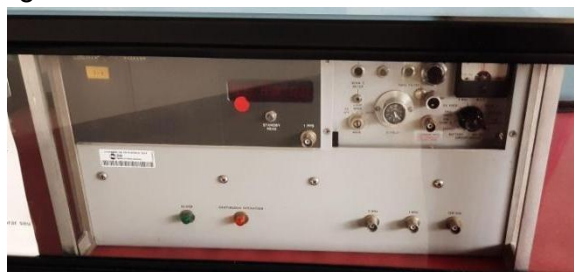
Figura 19: Padrão de césio 133. Fonte: Autoria própria, 2024.
