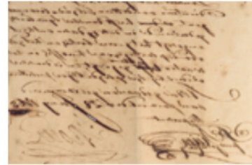
Figuras 1, 2, 3 e 4 (respectivamente) – Estágios de degradação da tinta ferrogálica.
