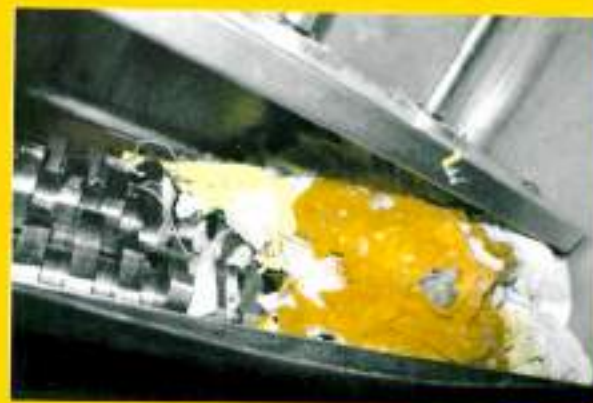
Sempre que possível, o rejeito radioativo é triturado e compactado porque ficará armazenado por muitos anos
