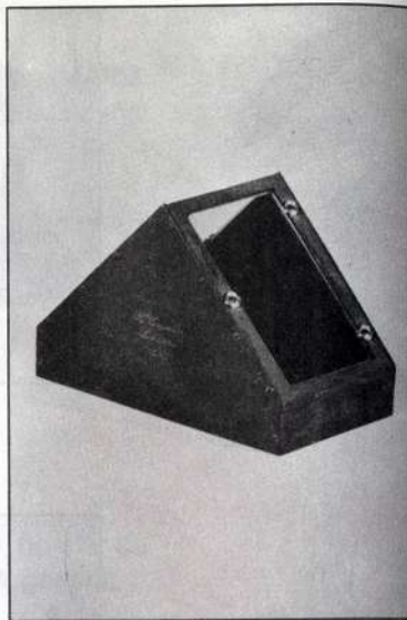
Horizonte artificial de mercúrio
