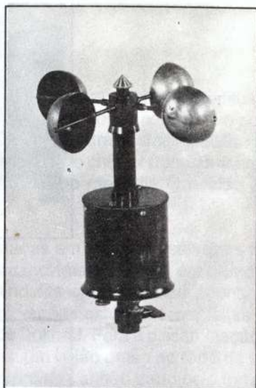
Anemômetro elétrico de Fuess
