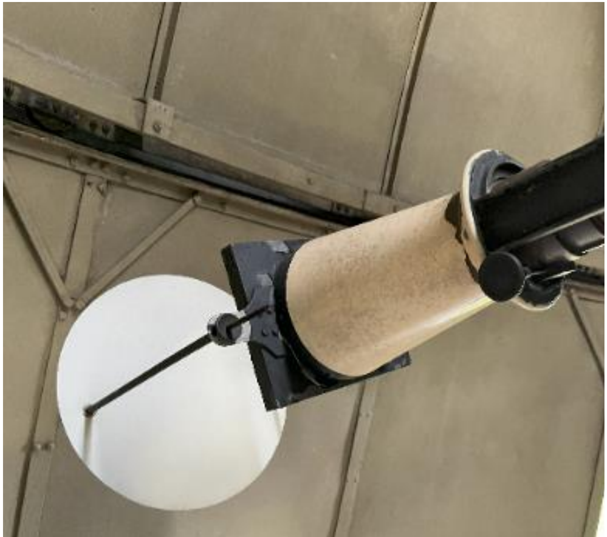
Figura 23: Fotografia da estrutura da ocular/câmera fotográfica, que foi adaptada para implementar suporte de observação visual para observação das manchas solares
