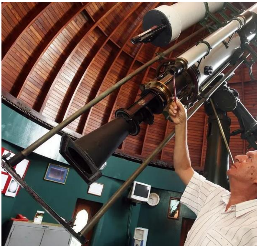
Figura 49 : Câmera fotográfica da Zeiss, instalada em luneta equatorial de 20 cm de abertura no Observatório da Universidade de Istambul
