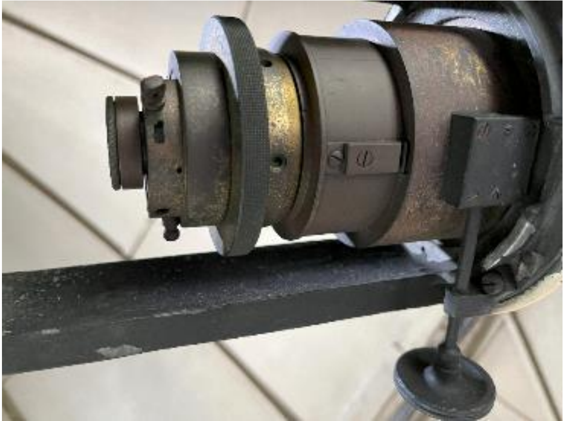
Figura 22 : Fotografia da estrutura da ocular/câmera fotográfica, não se apresenta alterada, restando sistema de diafragma e obturador
