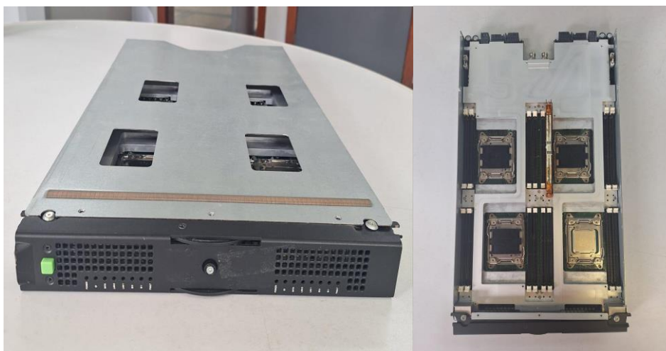
Figuras 24 e 25 - Servidor Blade Supercomputador Santos Dumont fechada e aberta
