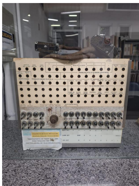
Figura 39 - Equipamento de teste I/O para máquina IBM 3704
