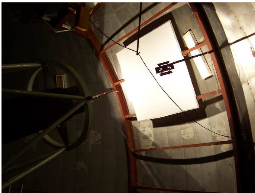
Figura 3.14 Lâmpadas de flat-field da cúpula acionadas.
