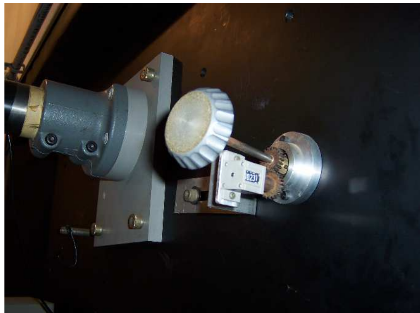
Figura 3.7 Detalhe do seletor de ajuste fino do ângulo da rede de difração (nota: a caixa com botões amarelo e verde ao lado direito – não visível nesta figura – serve para um ajuste mais grosseiro).
