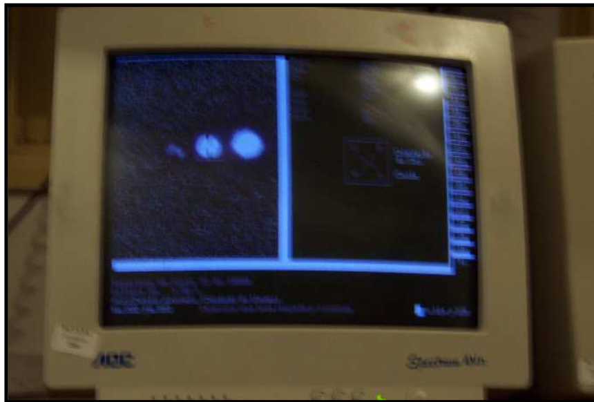
Figura 3.10 Imagem tripla da estrela de guiagem formada por causa de reflexões no(s) filtro(s). O objeto escolhido deve ser sempre o “do meio”.
