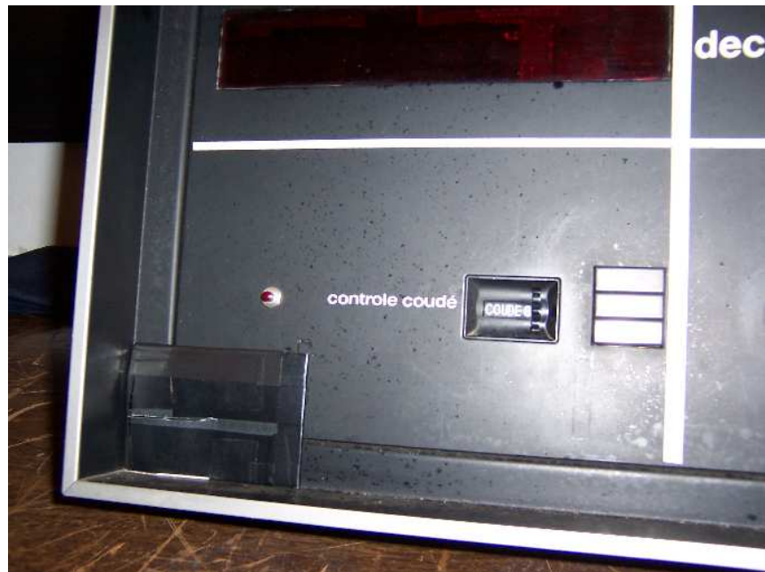
Figura 3.6 Detalhe do console de controle do Coudé (ajuste do espelho A, B ou C).
