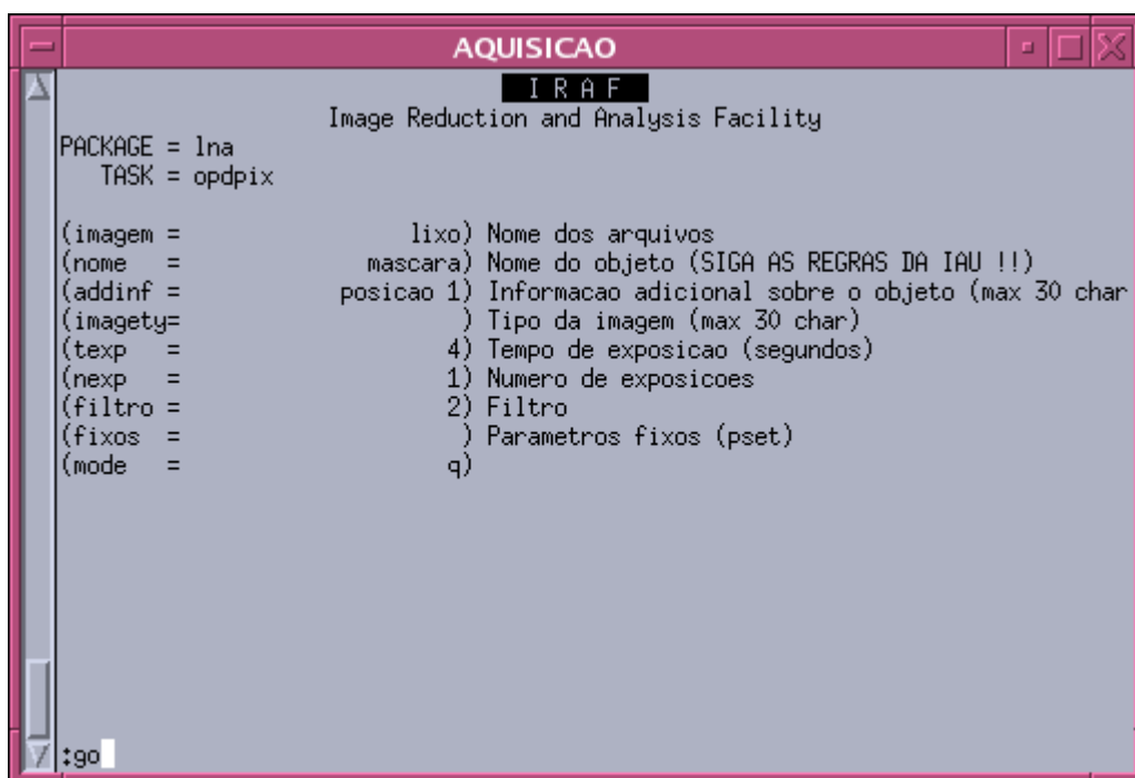
Figura 3.13: Parâmetros para a obtenção de uma imagem para verificação do posicionamento da máscara.
