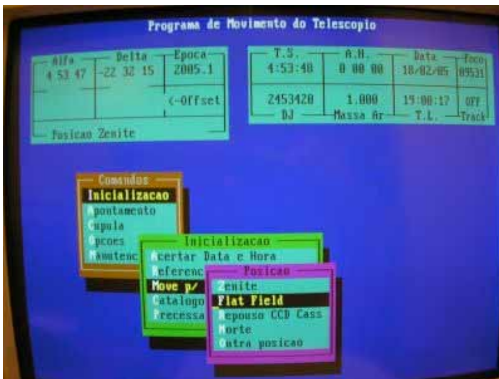
Figura 3.34: Comandos no terminal de controle para o posicionamento do telescópio para obtenção de imagens de flat field.
