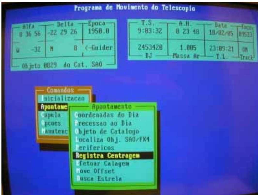
Figura 3.88: Processo de centragem e anulamento do offset do telescópio.
