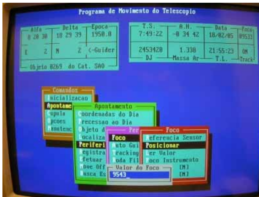
Figura 3.81: Seqüência de comandos para modificar o foco no terminal de controle.
