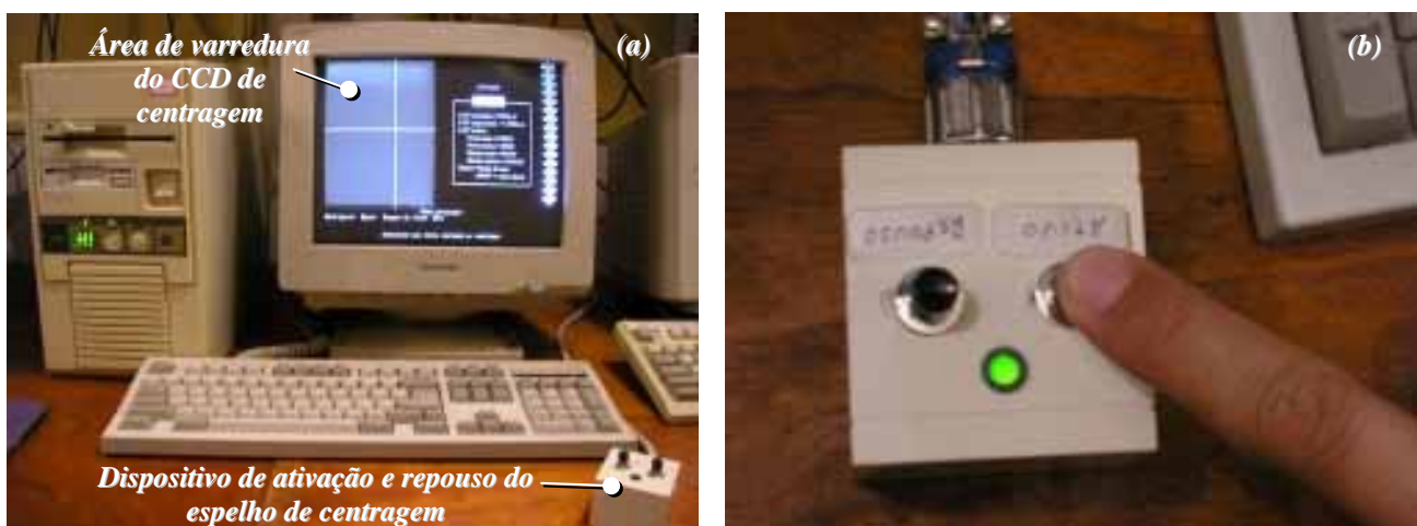
Figura 3.59: (a) O terminal de centragem. (b) Detalhe do dispositivo de ativação e repouso do espelho para centragem.
