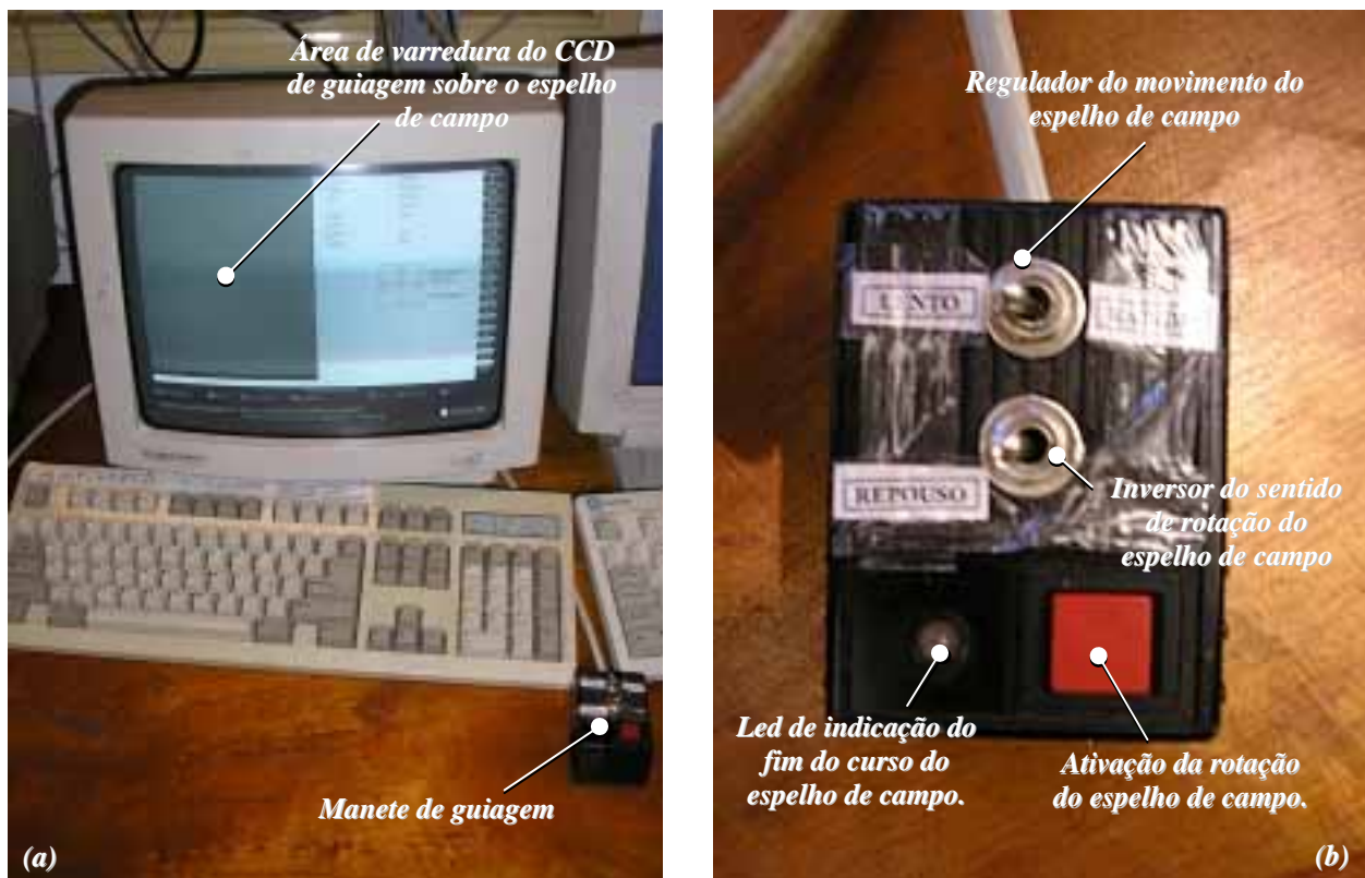
Figura 3.74: (a) Terminal de guiagem. (b) Detalhe do manete de guiagem.
