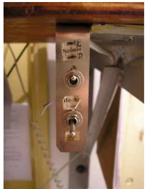
Figura 3.49:Chaves de ativação das lâmpadas de calibração. Neste exemplo a lâmpada de Ne-Ar está ligada (posição L) enquanto a de He-Ar está desligada (posição Desl.).
