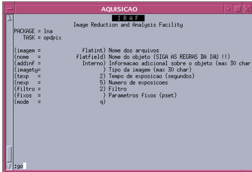
Figura 3.47: Parâmetros adequados para obtenção de imagens de flat field interno para a tarefa OPD.
