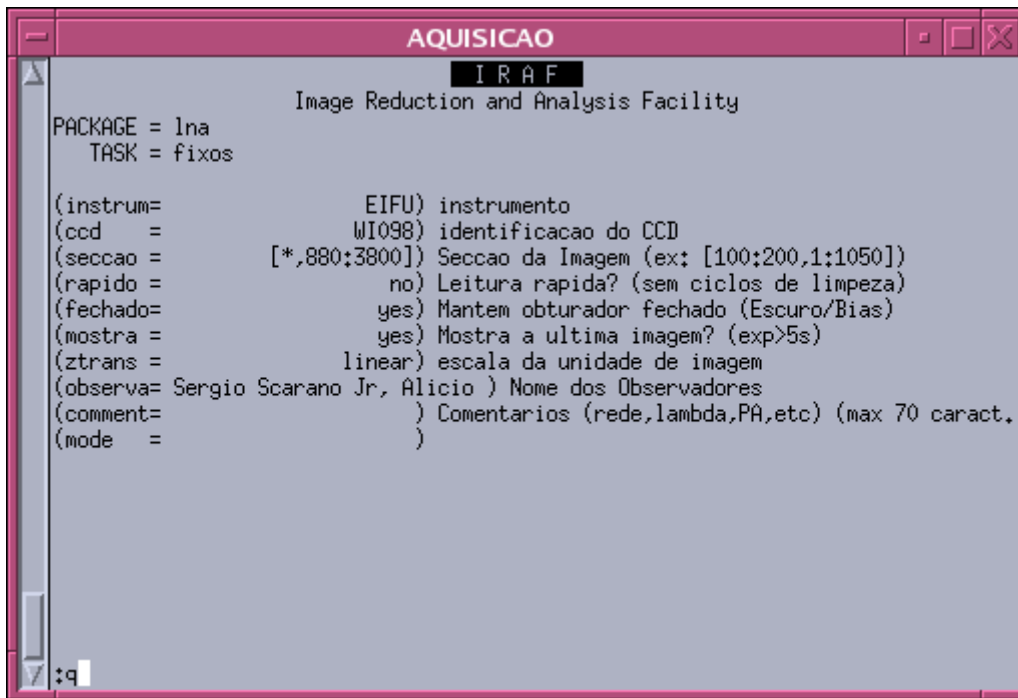
Figura 3.29: Parâmetros para tarefa FIXOS para obtenção de imagens de bias.
