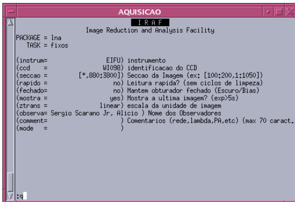
Figura 3.38: Parâmetros adequados para obtenção de imagens de flat field para a tarefa FIXOS.
