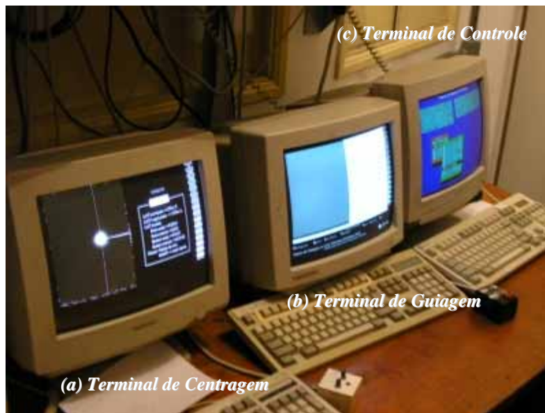
Figura 1.1: Terminais responsáveis pelo controle dos instrumentos. Da direita para esquerda temos (a) o terminal de centragem, (b) o terminal de guiagem e (c) o terminal de controle.
