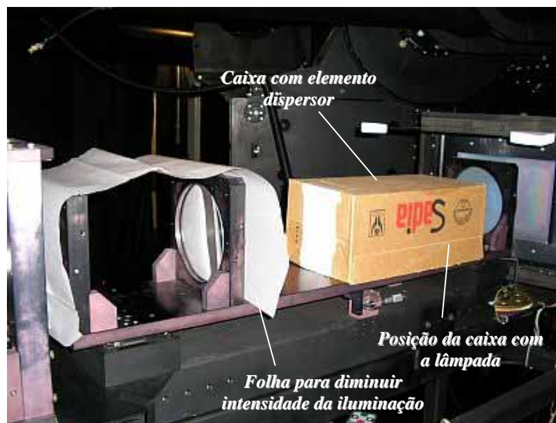
Figura 3.43: Disposição da caixa com elemento dispersor e da lâmpada no espectrógrafo..
