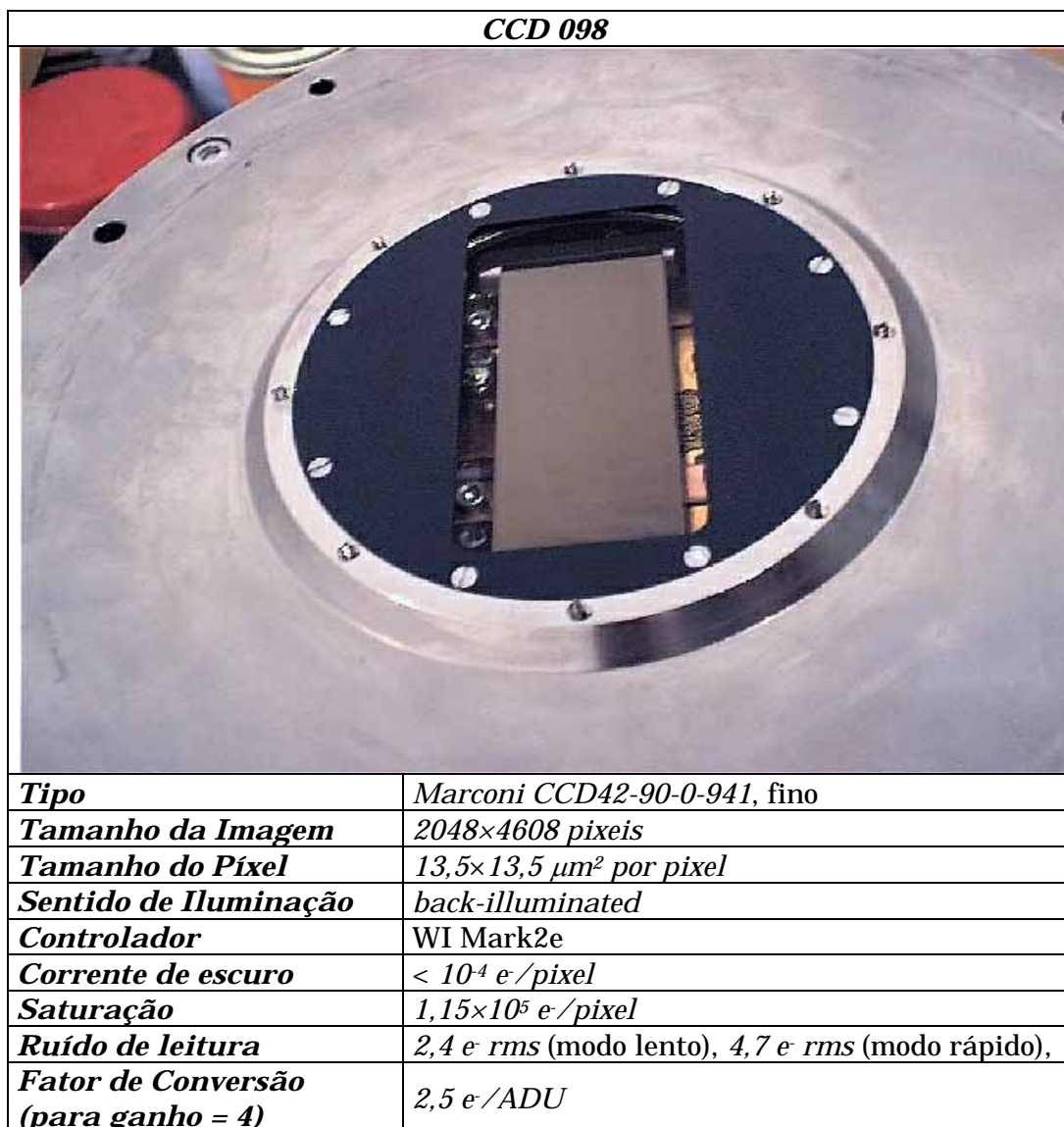
Figura 2.6: Imagem e características gerais do CCD 098.
