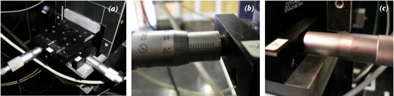
Figura 3.8: (a) Micrômetros dispostos perpendicularmente. (b) Micrômetro de posicionamento da máscara na direção y . (c) Micrômetro de posicionamento da máscara na direção x .
