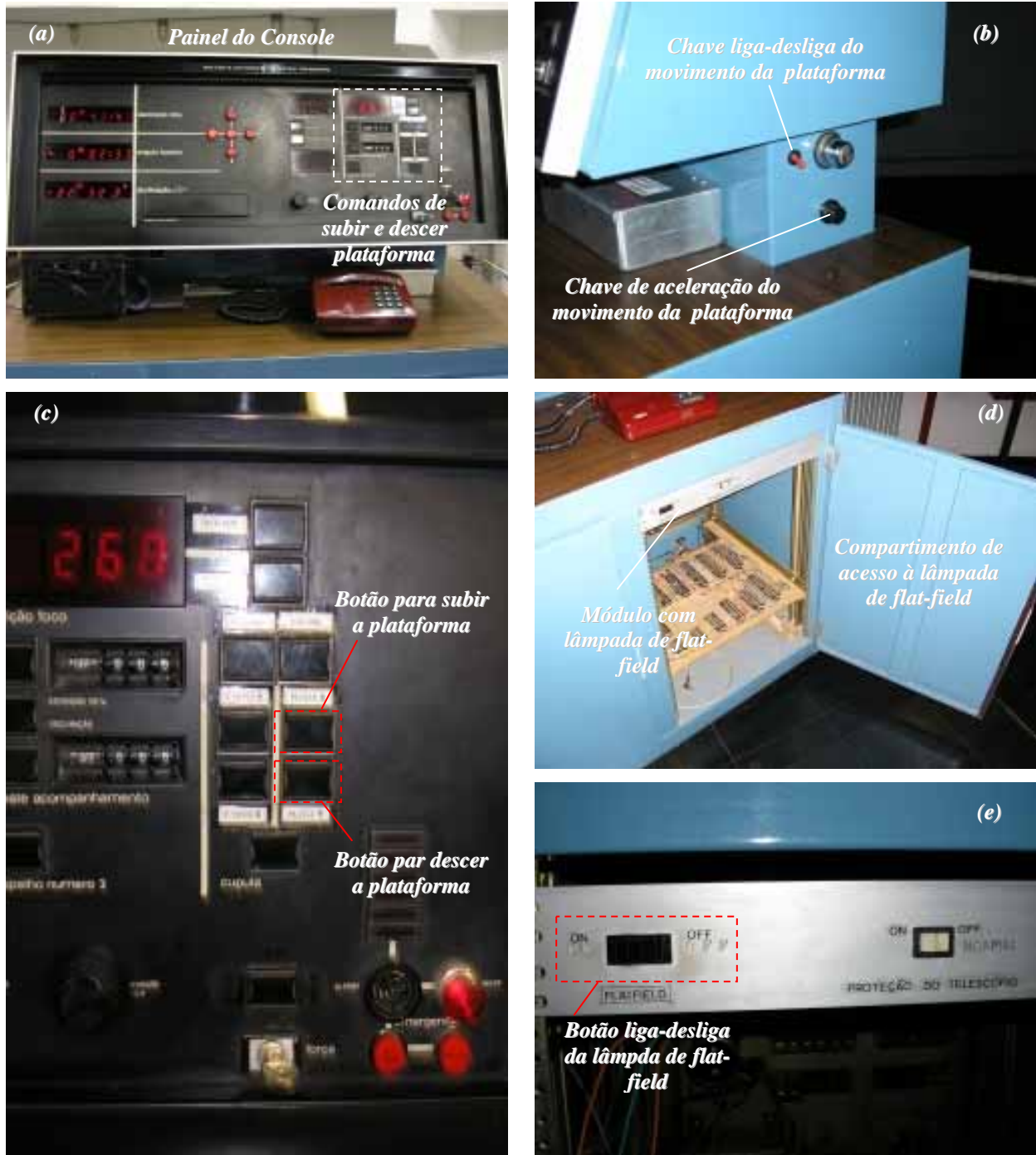
Figura 3.33: Imagens do console. (a) Painel do console. (b) Lateral direita do console, onde se encontram a chave de acionamento do movimento da plataforma e a chave de aceleração da mesma. (c) Botões para subir e descer a plataforma do telescópio, localizados na região direita do painel do console. (d) Compartimento abaixo do painel do console, onde se encontra o botão liga-desliga da lâmpada de flat-field. (e) Detalhe do módulo de acionamento da lâmpada de flat-field e botão liga-desliga da lâmpada.
