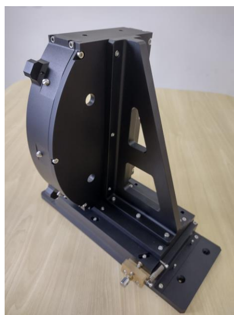
Figura: Suporte do espelho colimador
