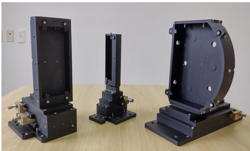
Figura. Suportes espelhos relay, plano e colimador
