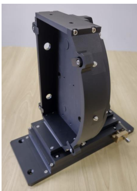
Figura: Suporte do espelho colimador
