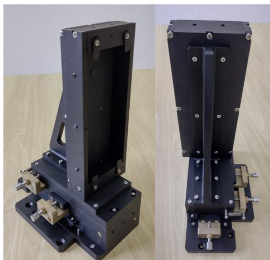
Figura: Suporte do espelho Relay
