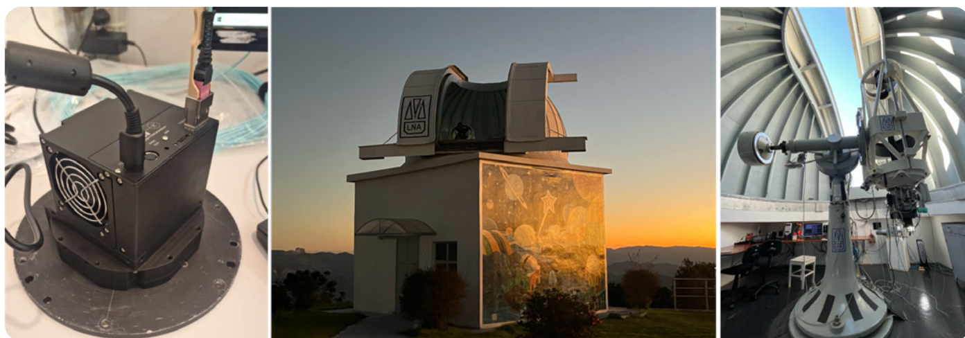
Figura 1. Nova câmera Kepler KL4040 instalada no telescópio Zeiss. À esquerda, apresenta-se a câmera Kepler KL4040 em bancada, instalada na flange adaptadora da CAM2. Ao centro, observa-se uma imagem do prédio que abriga o telescópio Zeiss, obtida ao entardecer durante a missão de comissionamento. À direita, é apresentado o telescópio Zeiss, equipado com espelho primário de 60 cm de diâmetro, o instrumento CAM2 e a nova câmera Kepler KL4040.
