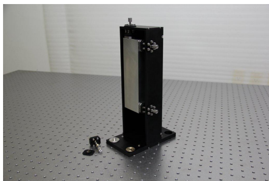
Protótipo do sistema de posicionamento de precisão simulando o suporte para um espelho
