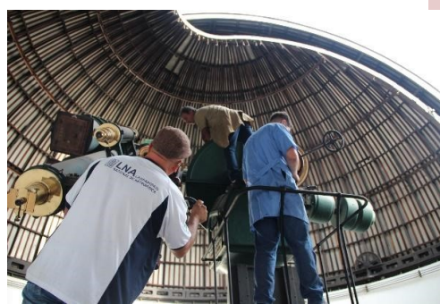
Equipe técnica do OPD avalia a luneta de 46cm e executa a manutenção necessária
