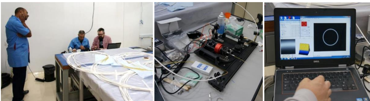
Figura 1.5.3 - Testes óticos no LNA para medição da taxa de degradação focal (FRD) das fibras no cabo.
