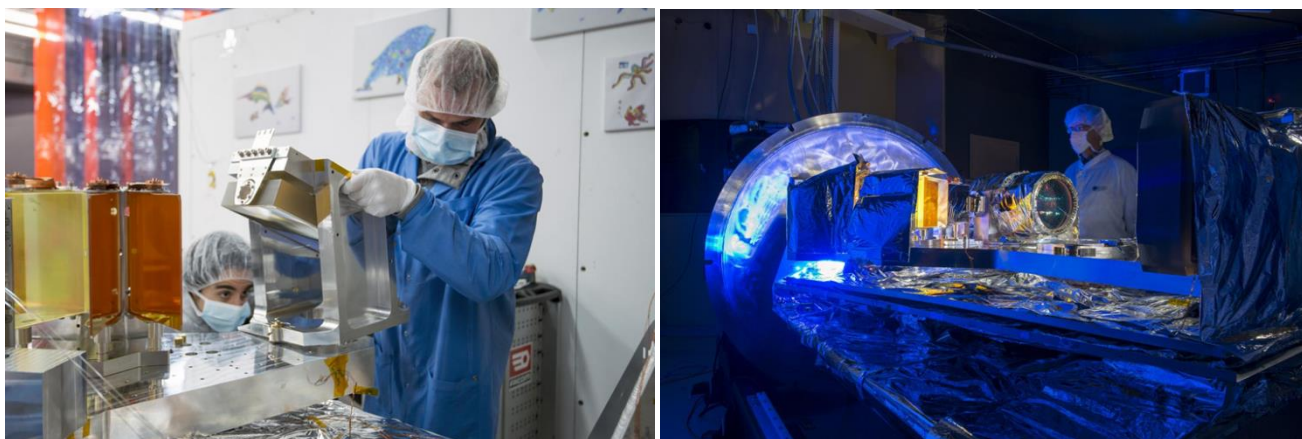
Figura 1.6.2 – A) Montagem da bancada óptica do SPIRou. O prisma de ZnSe aparece montado à esquerda e a rede echelle R2 aparece sendo montada à direita (© S. Chastanet - CNRS/OMP). B) vista do espectrógrafo SPIRou insteiramente montado e alinhado aguardando para ser fechado em sua câmara criogênica para o primeiro ciclo térmico (© S. Chastanet - CNRS/OMP).
