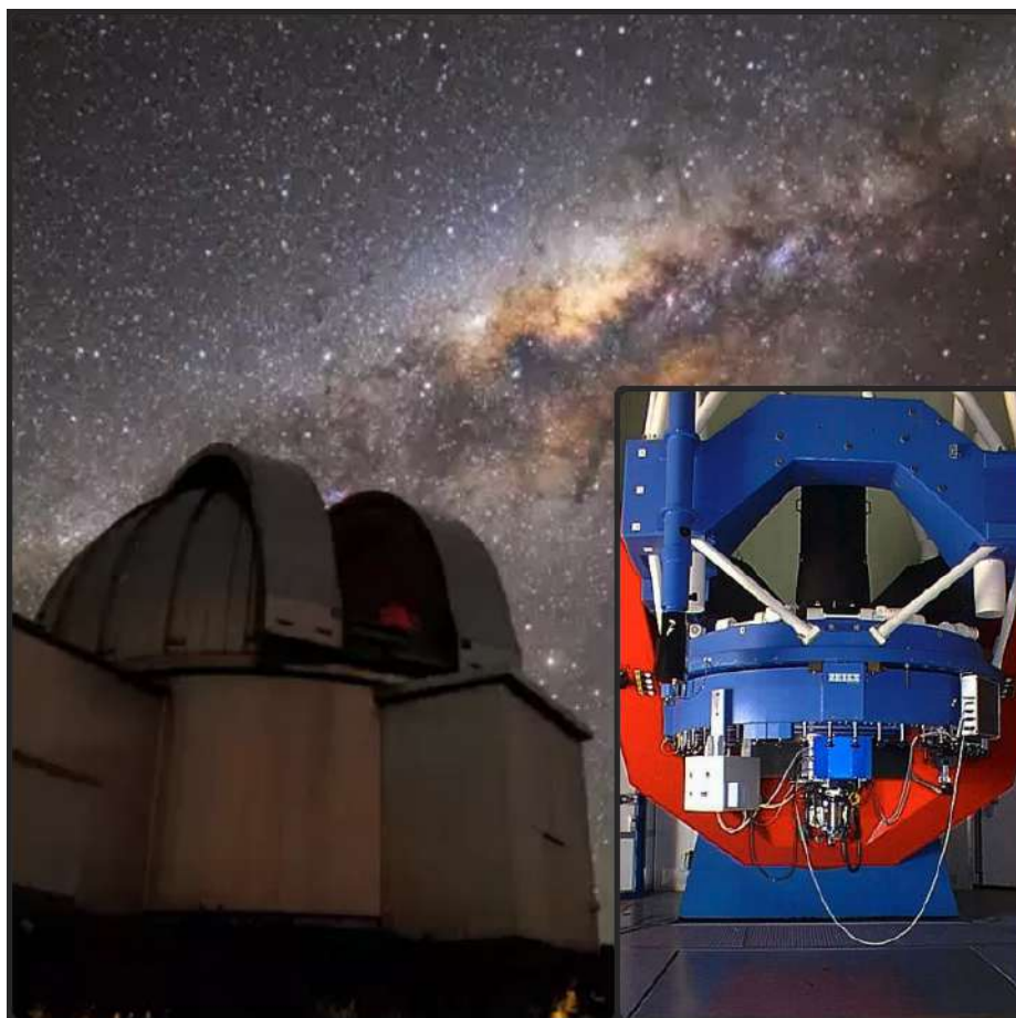
Figura 1: Telescópio La Silla de 2,2 metros do ESO. (Inset) A montagem do telescópio com o Wide Field Imager (WFI), uma câmera do tipo redutor focal no foco Cassegrain e com um campo de visão de 34' \times 33' , Nyquist amostrado em 0,238'' pixels excedendo qualquer outro instrumento do ESO em um fator de 2. Oferece excelente sensibilidade de 350 nm a infravermelho próximo, com mais de 40 filtros disponíveis simultaneamente, muitos deles especificamente selecionados para apoiar a determinação de redshifts fotométricos de objetos distantes. Crédito: Instituto Max Planck de Astronomia, Heidelberg, Alemanha.
