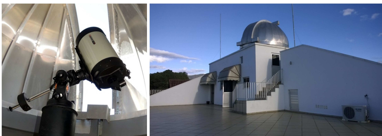
Fig. 4 - Visão inferior do novo Telescópio do OnT, instalado no pilar em montagem equatorial. Trata-se de um telescópio Celestron de 11 polegadas de diâmetro, automatizado. À esquerda vê-se o contrapeso, ao centro, apoiado na cunha (pequeno pilar negro com dois anéis cor de laranja) está o controle manual (caixa negra com botões brancos), e à direita vê-se o tubo metálico que abriga os espelhos. O trilho (dovetail) através do qual o tubo é fixado à cunha foi projetado por Magno e usinado na Oficina Mecânica do LNA.
