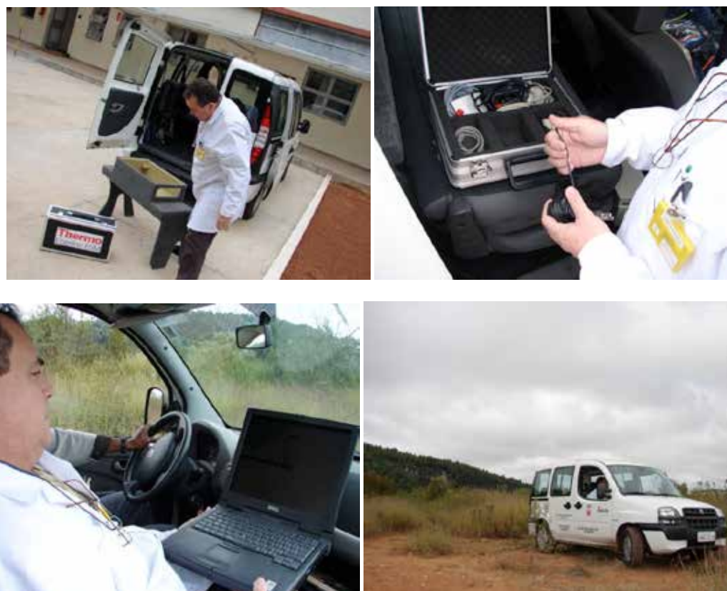
Figura 7 – Fotos da adaptação do carro com o equipamento da medição da radiação gama terrestre realizada por técnicos do LAPOC-CNEN e da Secretaria de Estado de Saúde de Minas Gerais
