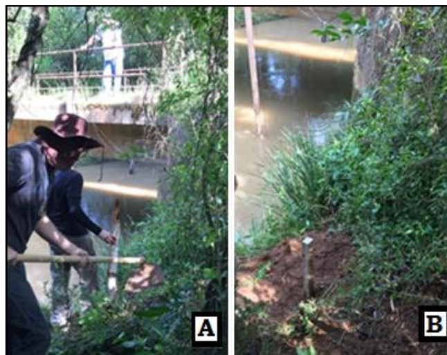
Figura 21 - A: Limpeza e manutenção dos pontos de amostragem. B: Instalação das estacas de madeira nas margens na seção de amostragem.
