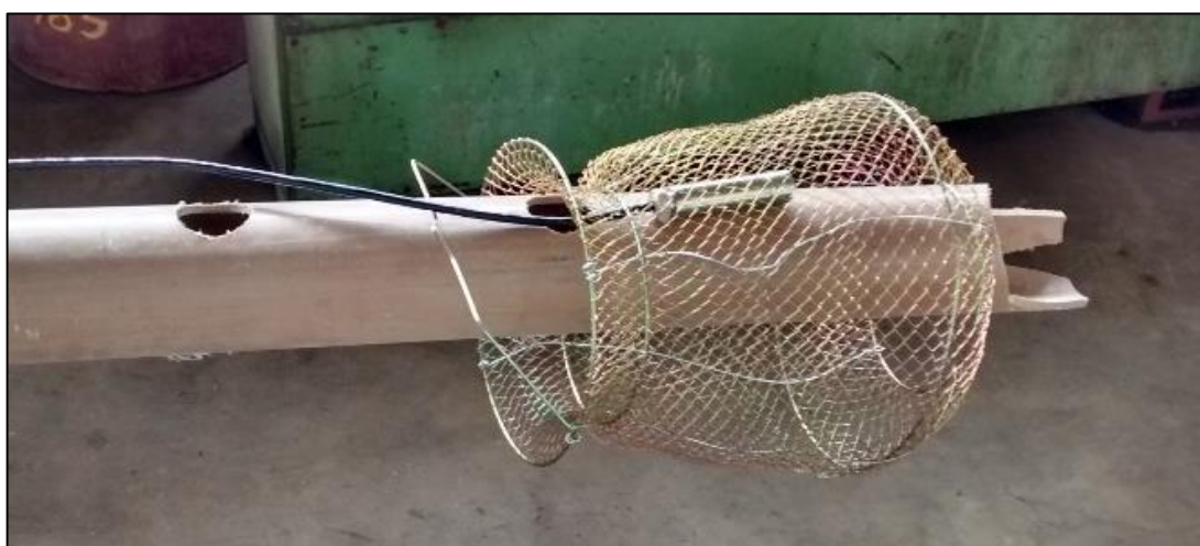
Figura 18 - Preparação do suporte dos sensores de nível d'água e de turbidez a serem instalados definitivamente no Ribeirão das Antas.
