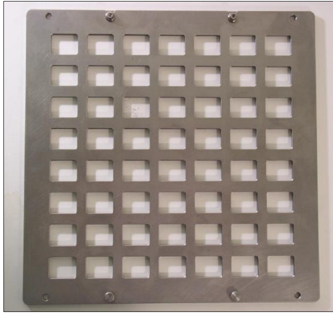
Figura 7 - Bandeja metálica com placa de retenção, com capacidade para 49 detectores.
