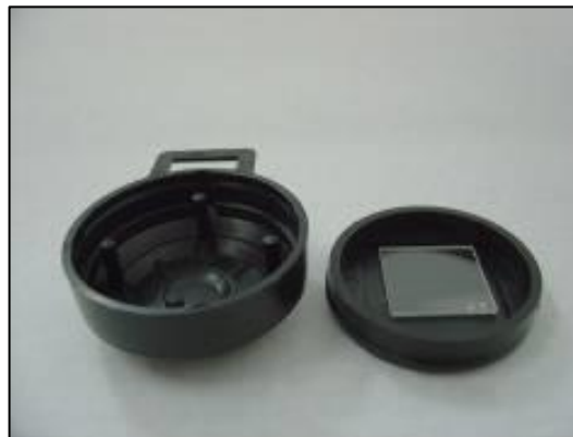
Figura 6 – Conjunto aberto formado por detector CR-39 e câmara de difusão (base e tampa). Fonte: Da autora.
