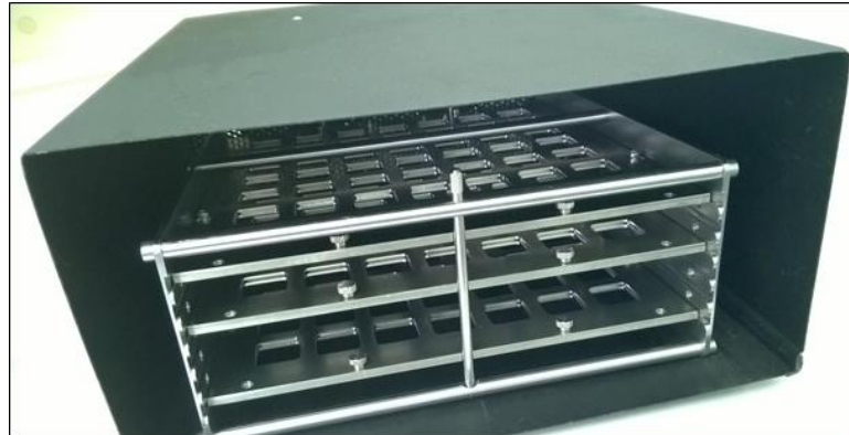
Figura 8 - Suporte metálico contendo 3 bandejas, disposto em secadora. Fonte: Da autora.
