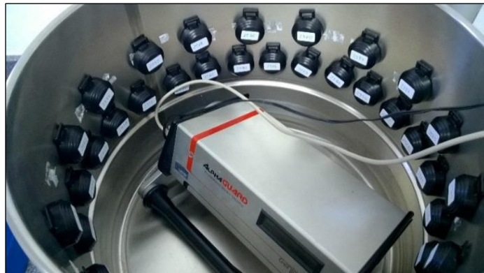
Figura 15 - Interior do contêiner, onde encontram-se o detector AlphaGUARD e 40 dosímetros (fixados aleatoriamente às paredes do contêiner).
