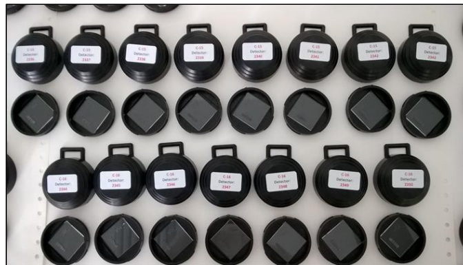
Figura 9 - Câmaras de difusão identificadas com respectivos detectores posicionados. Fonte: Da autora.
