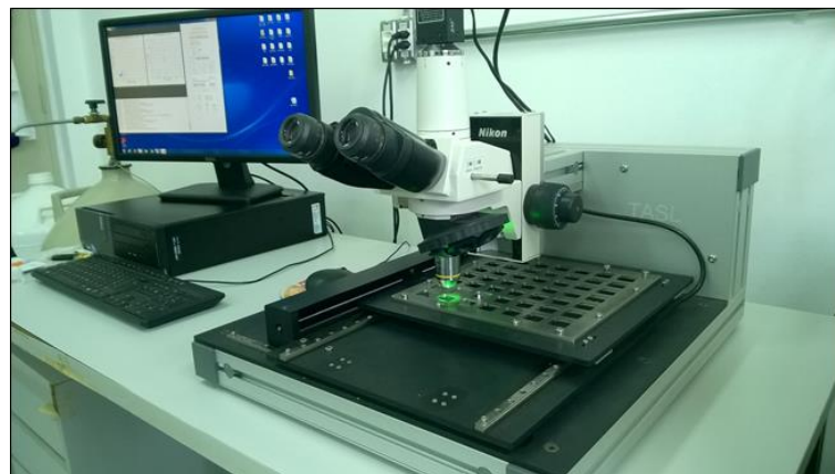
Figura 10 - TASLIMAGE: Sistema composto por mesa x-y-z, microscópio óptico e software desenvolvido para a detecção, contagem e análise de traços nucleares.
