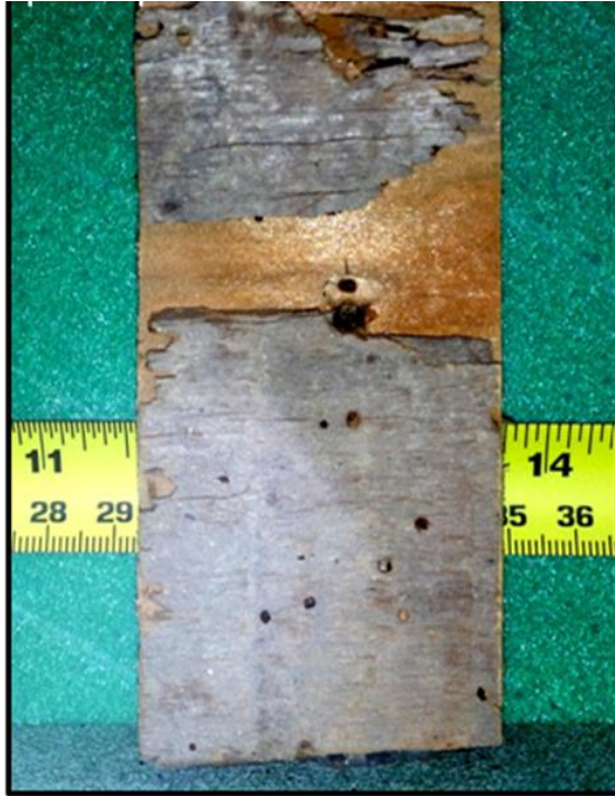
Figura 27. Amostra de madeira que foi inspecionada pela técnica da radiografia com nêutrons em tempo-real.
