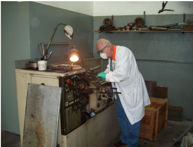
Figura 55. Dr. Reynaldo usinando um dos filtros de Bismuto no Torno Mecânico para a retirada de 0,5mm de espessura do objeto.
