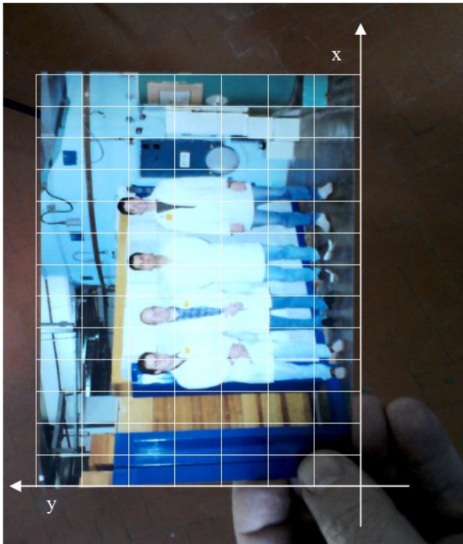
Figura 32. Exemplificação do processo de digitalização de uma fotografia analógica bidimensional por uma câmera digital. Cada quadrado na figura no eixo (x,y) ilustra um pixel.
