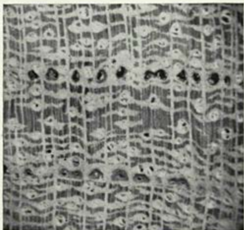
Foto 1 — Aspecto macrográfico da secção transversal do lenho (x10).
