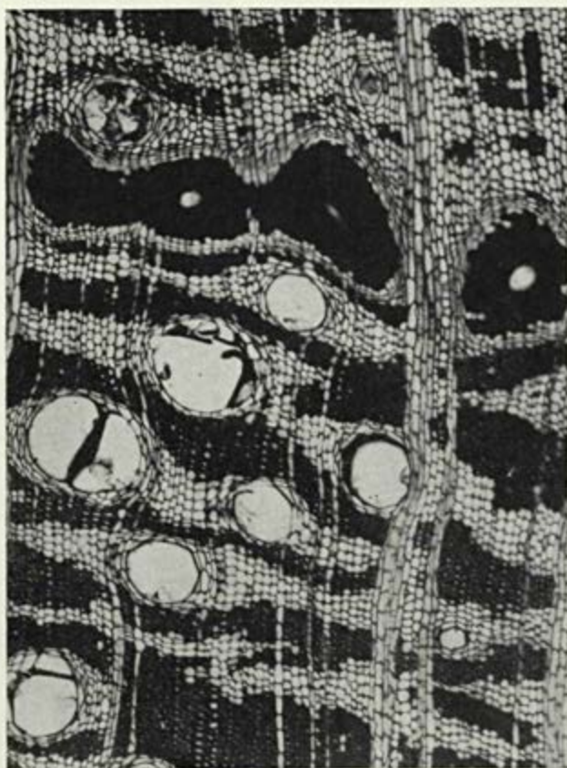
Foto 2 — Secção transversal (x50). Presença de canais de goma em fileiras tangenciais.
