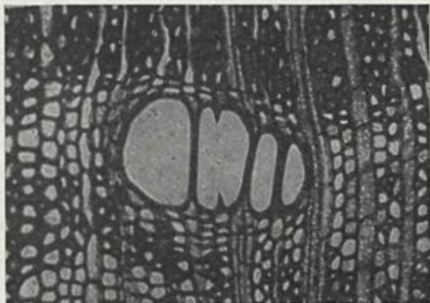
Foto 12 — Perfuração na parede lateral radial de dois elementos de um vaso (x170).
