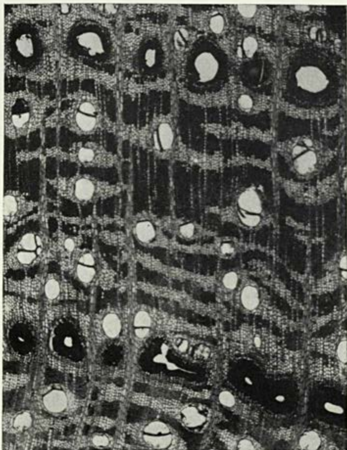
Foto 6 — Secção transversal mostrando duas fileiras de canais de goma com disposição em anel (x35).
