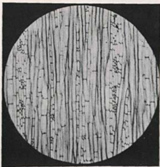
PAU DE Balsa ( Ochroma sp. Bombacaceas) . Exemplo de baixo peso específico
