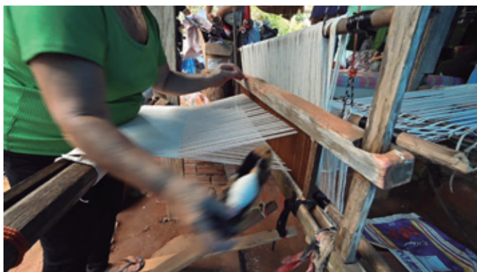
Preparo da canela, onde o fio é enrolado, para ser encaixado na lançadeira, e passado de um lado a outro
