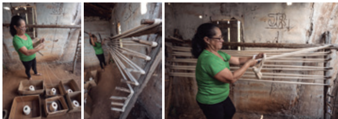
Dona Zulmira prepara a urdura, movimentando-se de um lado a outro do urdume
