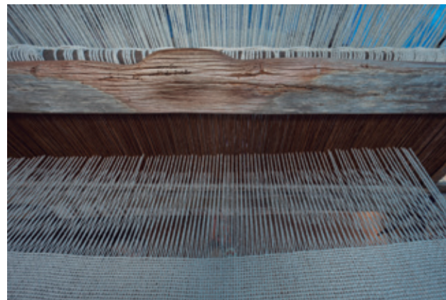
Batimento da trama com o pente, aproximando e ajustando os fios para dar forma ao tecido
