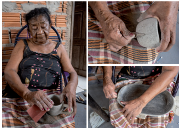
Marciana raspando peça com faca, lixando e burnindo com pedra de seixo | Macapá
