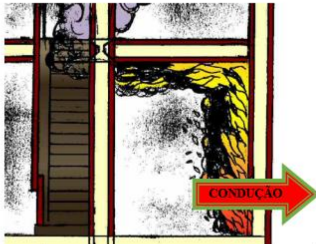
Figura 6: Transferência de calor por condução através da parede
