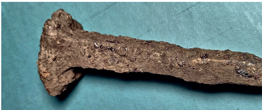
Imagem 29: corrosão líquida do ferro - gotículas de água e íons cloreto. Créditos: Laboratório Multidisciplinar de Investigação Arqueológica da Universidade Federal de Pelotas (Lâmina/UFPel).
