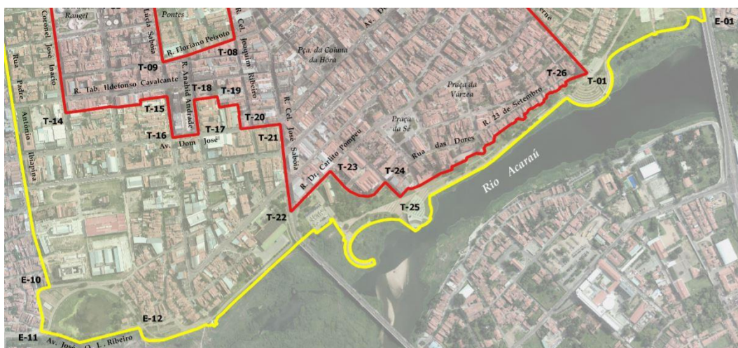
Figura 05: Exemplo de poligonais que apresentam mais vértices na tabela de coordenadas que pontos de referência no mapa (entre o ponto T-23 e o fechamento da poligonal no ponto T-01 e entre o ponto E-10 e o fechamento da poligonal no ponto E-01). Trecho do Conjunto Arquitetônico e Urbanístico de Sobral, na cidade de Sobral, CE Fonte: CGNT/DEPAM
