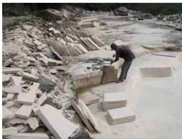
IMAGEM 35: Três Coqueiros, extração de pedras de piso para pavimentação. Foto: Autor, setembro de 2009.
