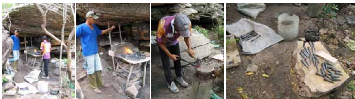
IMAGEM 36: Fole em funcionamento num abrigo na área de São Judas Tadeu, sobre a Serra do Tombador. Na sequência de imagens, da esquerda para a direita, percebem-se: visão geral do funcionamento da oficina; homem manobrando o fole; homem malhando uma ponteira sobre uma bigorna; ponteiros esfriando sobre uma rocha, ao lado de um galão de água. Fotos: Autor, fevereiro de 2009.
