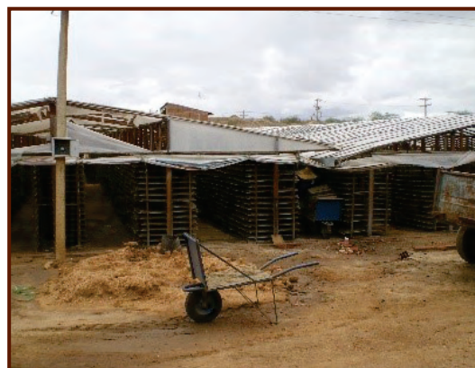
Figura 1: Cerâmica Bela Vista - fornos antigos do tipo caipira e secagem.
