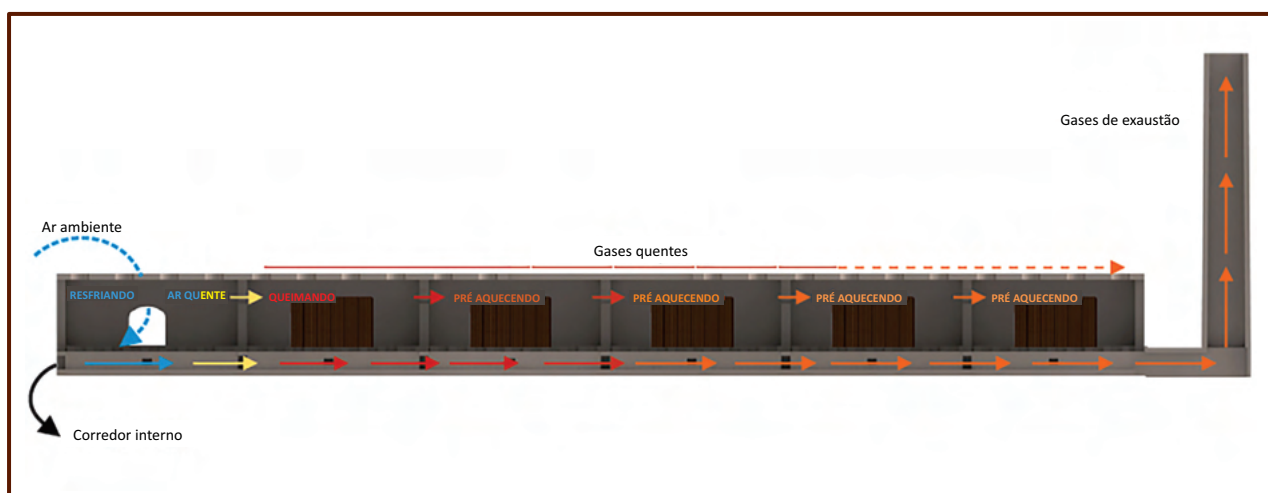
Figura 11: Fluxos de calor no forno Hoffmann.
