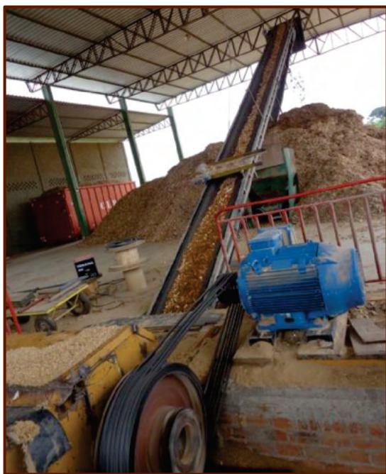
Figura 3: Picador utilizado na CLR.
