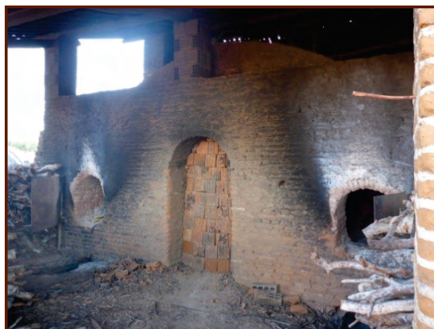
Figura 7: Cerâmica Pataxó - forno paulistinha.
